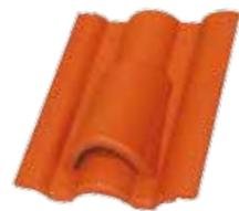
**Rubni crijepljivo:** element proizveden za jedinstvenu i stručnu izvedbu zabata. Učvršćivanje u svim slučajevima treba ostvariti otpornim na koroziju i olje. Kod rubnih dasaka treba ostaviti dovoljan razmak zbog pomicanja i širenja na toplini. U slučaju crijepe Danubia desni i lijevi elementi su isti po veličini.
