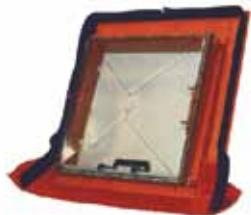
prvenstveno omogućuje jednostavan izlaz na krov. Pored toga osigurava prodror svjetla u potkrovanje, odnosno može imati i ulogu ventilacije. Plastično krilo prozora može se otvoriti prema gore, a sa blokadom spona cijeli otvor se može oslobođiti. Preporučuje se smještanje izlaza u blizini dimnjaka. Učvršćivanje se svakako mora vršiti za tesarsku konstrukciju pomoću remena montiranih na prozor. Oko prozora zatvaranje vode treba pažljivo napraviti.
