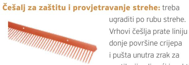
**Češalj za zaštitu i provjetravanje strehe:** treba ugraditi po rubu strehe. Vrhovi češlja prate liniju donje površine crijepta i pušta unutra zrak za ventilaciju ali veći insekti i ptice ne mogu ući pod pokrov. Češalj je napravljen od elastične plastike i njegovo učvršćivanje se može izvršiti sa zaptivanjem ili pomoću vijaka svakih cca. 20 cm. Može se primijeniti i kod uvala.
