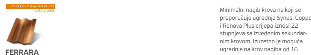
Minimalni nagib krova na koji se preporučuje ugradnja Synus, Coppo i Renova Plus crijepe iznosi 22 stupnjeva sa izvedenim sekundarnim krovom. Izuzetno je moguća ugradnja na krov nagiba od 16 stupnjeva uz ljepljene ili varene spojeve sekundarnog krova.
