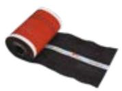
Distribuiran u roli, fleksibilan element za provjetravanje koji se može lako oblikovati. Može se ugraditi kod sljemenja i grebena, kod svih tipova crijepljiva. Simetrično i u dvije linije kontinuirano perforiran podmetač preko kojeg se vrši provjetravanje. Materijal je učvršćen s metalnom mrežom, stoga je otporan na vremenske utjecaje. Trajno se može nalijepiti samo na suhu površinu crijepljiva na kojoj nema prašine, masti ili ulja. Niske temperature mogu utjecati na kvalitetu ljepljenog spoja.
