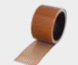
Obično se ugrađuje po rubu strehe i omogućava ventilaciju ispod pokrova. Traka propušta zrak unutra, ali veći insekti i ptice ne mogu ući pod pokrov. Kod valovitog crijeplja koristi se zajedno sa češljjem za zatvaranje. Traka je napravljena od elastične plastike i učvršćivanje se vrši mehaničkim putem, na svakih cca. 20 cm-a radi boljeg prianjanja.
