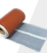
Fleksibilan element koji služi za zatvaranje priključaka dimnjaka i zidova krova. Temeljni materijal je aluminij, sa slojem ljeplila na stražnjoj strani, koji ni na utjecaj topline ne gubi sposobnost prianjanja. Može se lako oblikovati rukom, prianja uz površinu crjepova. Osigurava trajnu zaštitu od prodora kiše i snijega. Isključivo se može lijepti na suhu površinu na kojoj nema prašine, masti i ulja.
